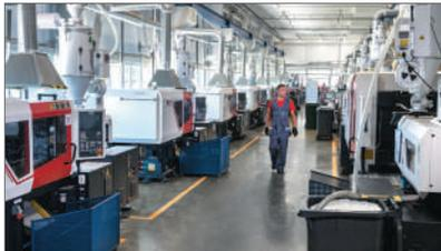
Термопластавтоматы для производства литых изделий
