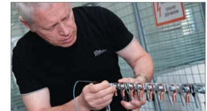
Испытания контактных паст
