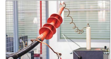
Высоковольтные испытания кабельных муфт
