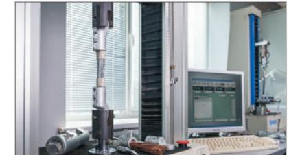
Испытания наконечников на разрывное усилие
