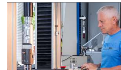
Испытания наконечников на разрывное усилие
