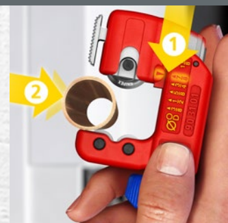
... установите шкалу и закрепите на трубе с помощью подпружиненного режущего диска
